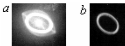
4 pav. Pjezokeraminio elemento galo trajektorija: a – aukštadažnio elektrinio signalo padavimo pjezokeraminio elemento elektrodams momentu; b – esant nusistovėjusiam darbo režimui
